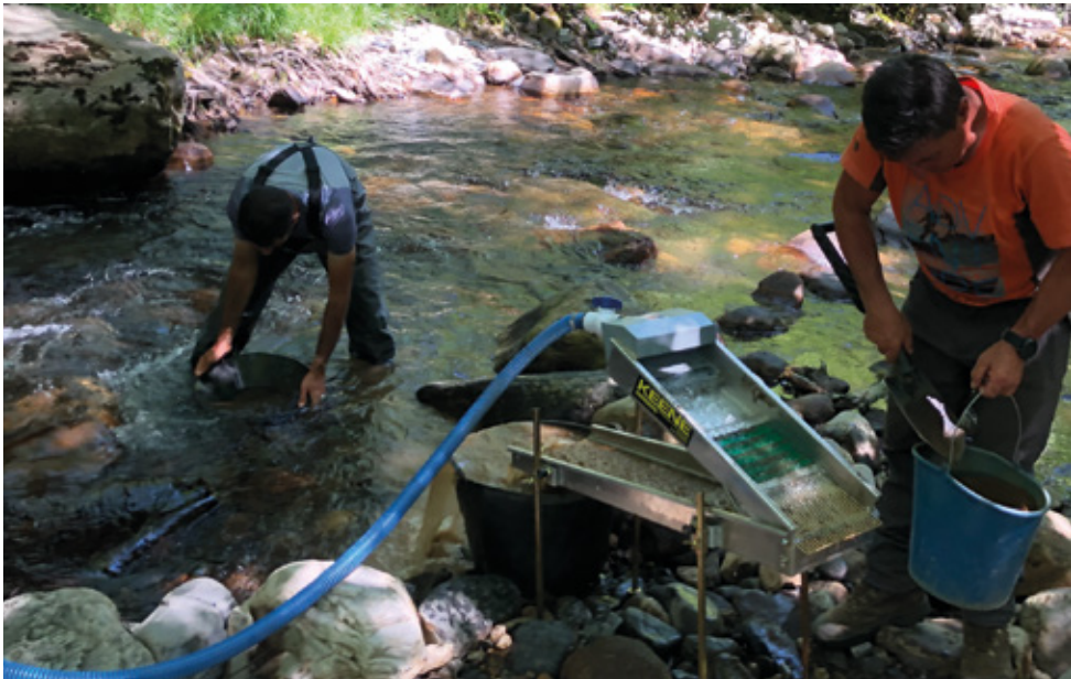
Figura 9. Prospección a la batea y uso de esclusa motorizada para la recuperación de oro en el río Burbia. Labores autorizadas por la Confederación Hidrográfica del Miño-Sil. Elaboración propia.
